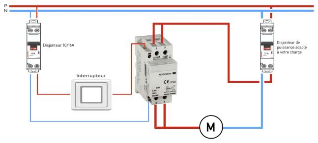
La bobine du relais (Broches A1 et A2) est alimentée par le dispositif de commande de faible capacité de commutation tel un interrupteur standard ou bien l'une des sortie relais d'un VM160 ou VM208. La commutation de puissance se fait au niveau des broches 1 à 4 suivant le schèma ci dessus. Si vous n'avez qu'une seule charge vous shunterez les broches 1-3 et 2-4 tel le schèma ci dessus.
